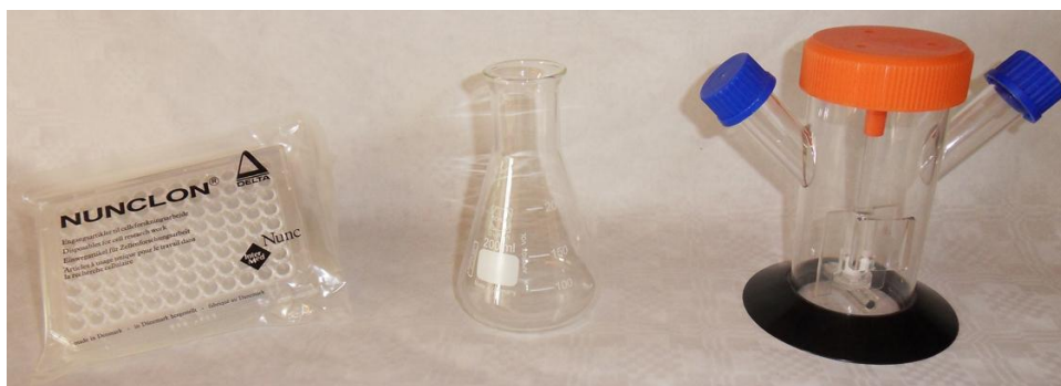
Abbildung 1: Mögliche Bioreaktoren (Mikrotiterplatte, Erlenmeyerkolben, Einwegrührreaktor) für Screeningversuche
